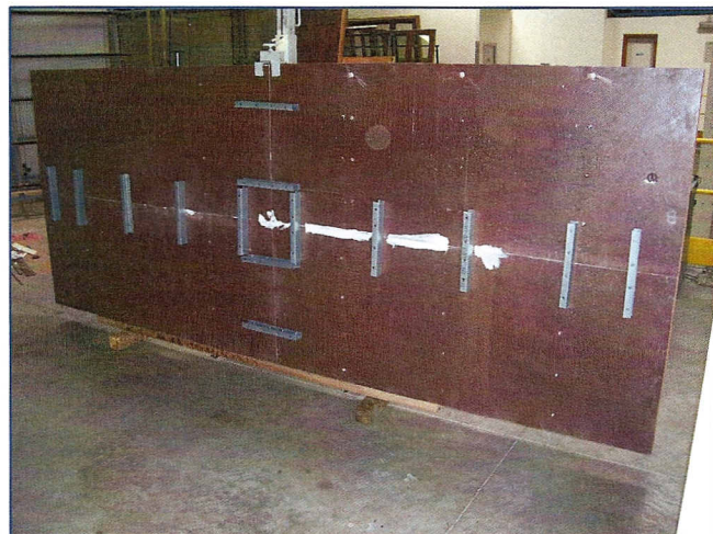
Parete esterna campione – Lato interno
