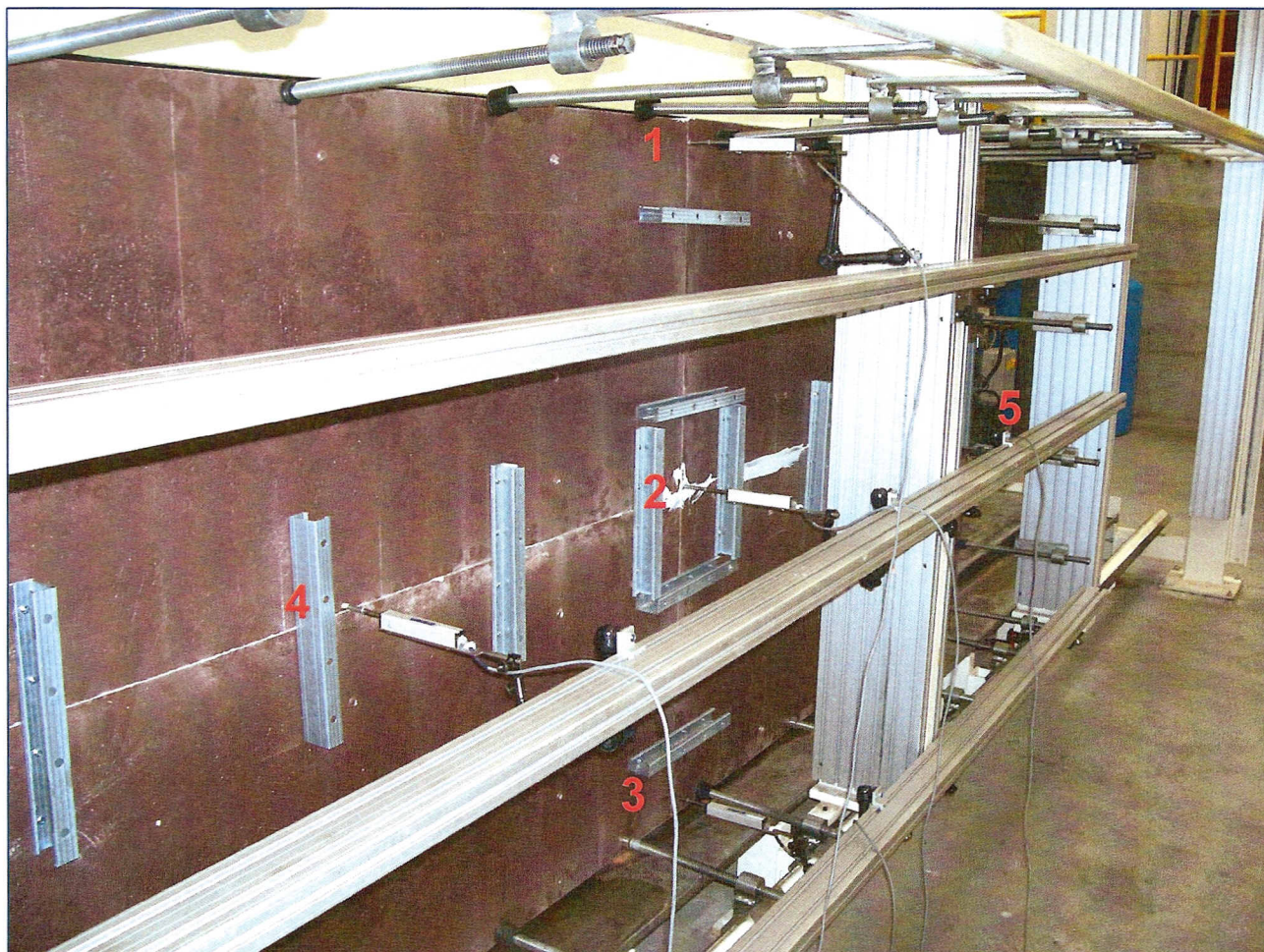
Fotografia del campione e dei sensori di spostamento durante la prova
